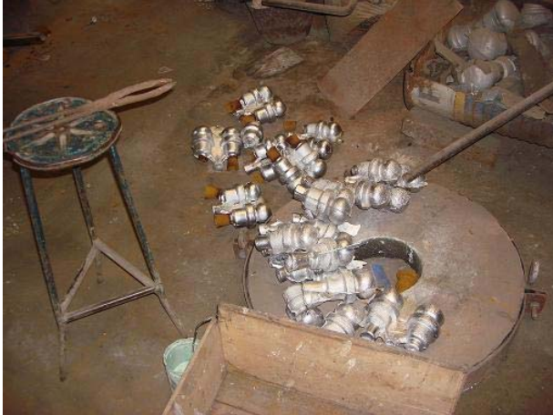
FOTO 10 / MATERIAL YA FUNDIDO PARA LA CONSTRUCCIÓN DE REJAS EN LA VÍA PUBLICA.
